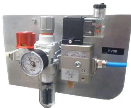
**Nota:** è necessario che l'utilizzatore inserisca a monte del punto di allacciamento della macchina alla rete pneumatica dello stabilimento, una valvola di intercettazione al fine di poter eseguire qualunque lavoro di manutenzione sulla macchina stessa.
